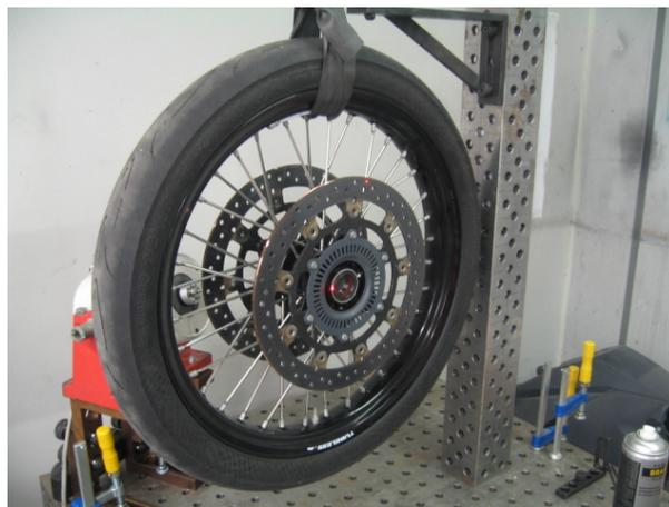
Abbildung 6.3: Prüfaufbau für Laservibrometer-Messung
