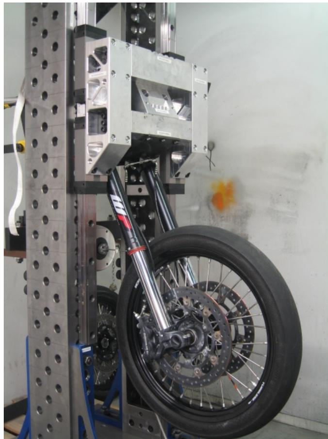
Abbildung 6.6: Fahrwerkprüfstand
