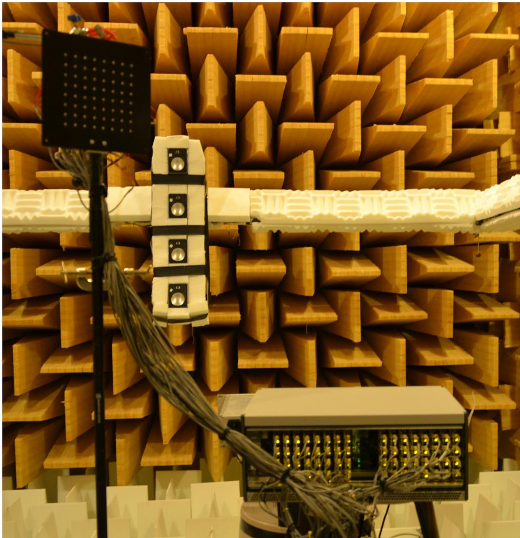
Abbildung C.10: Nahfeld-Holografie mit einem planaren Mikrofonarray.
