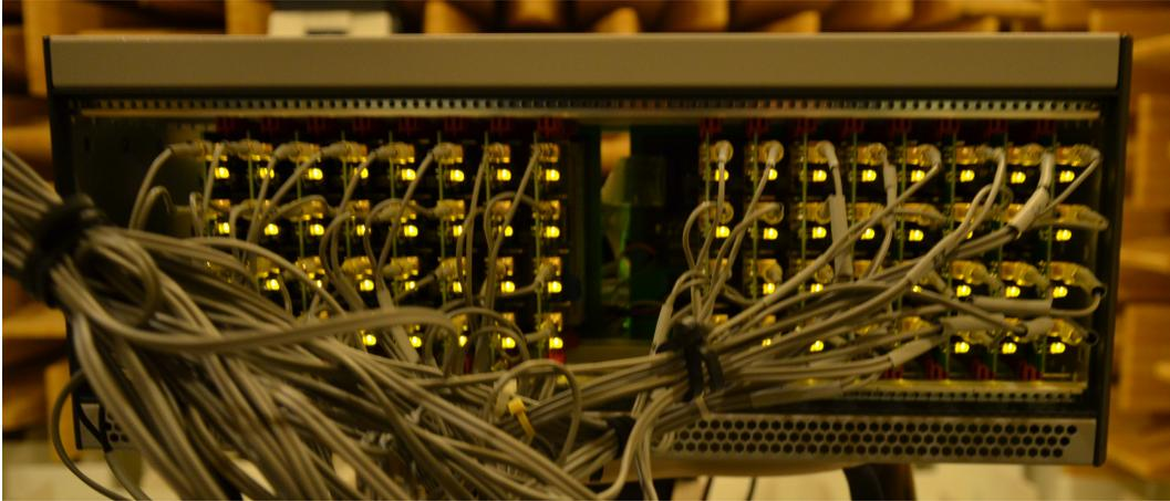
Abbildung C.8: 4-Kanal Interface-Karten im Betrieb eines 64-Kanal Mikrofonarrays.
