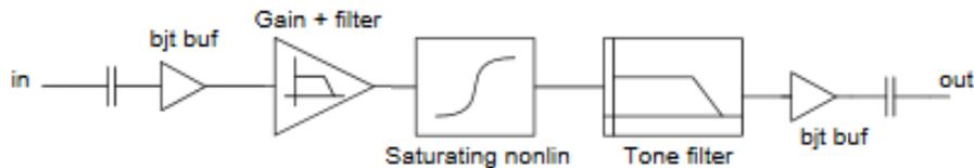
Abbildung 8: Blockschaltbild eines Distortion Pedals<sup>4</sup> [7]
