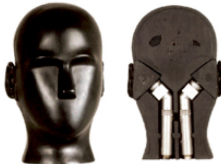
Abbildung 3 – 1973 brachte die Firma Neumann den ersten kommerziellen Kunstkopf KU80 heraus [Pau09]
