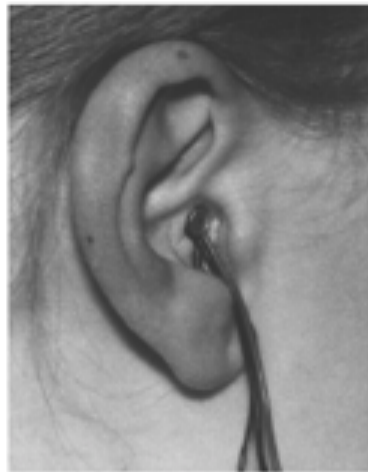
Abbildung 10 – Kopfmikrofonanfertigung - realisiert mit Hilfe eines Sennheiser KE 4-211-2 Mikrofons am Eingang des Ohrkanals einer realen Person - angefertigt an der Universität Aalborg [HM05]
