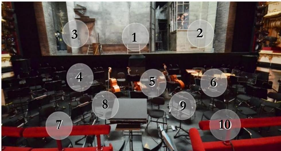
*Abbildung 29: Lautsprecherpositionen im Orchestergraben und auf der Bühne während der Aufnahme der Impulsantworten. Dabei wurde ein aktiver Lautsprecher an die verschiedenen Positionen gesetzt (Frühwirt 2021)*
