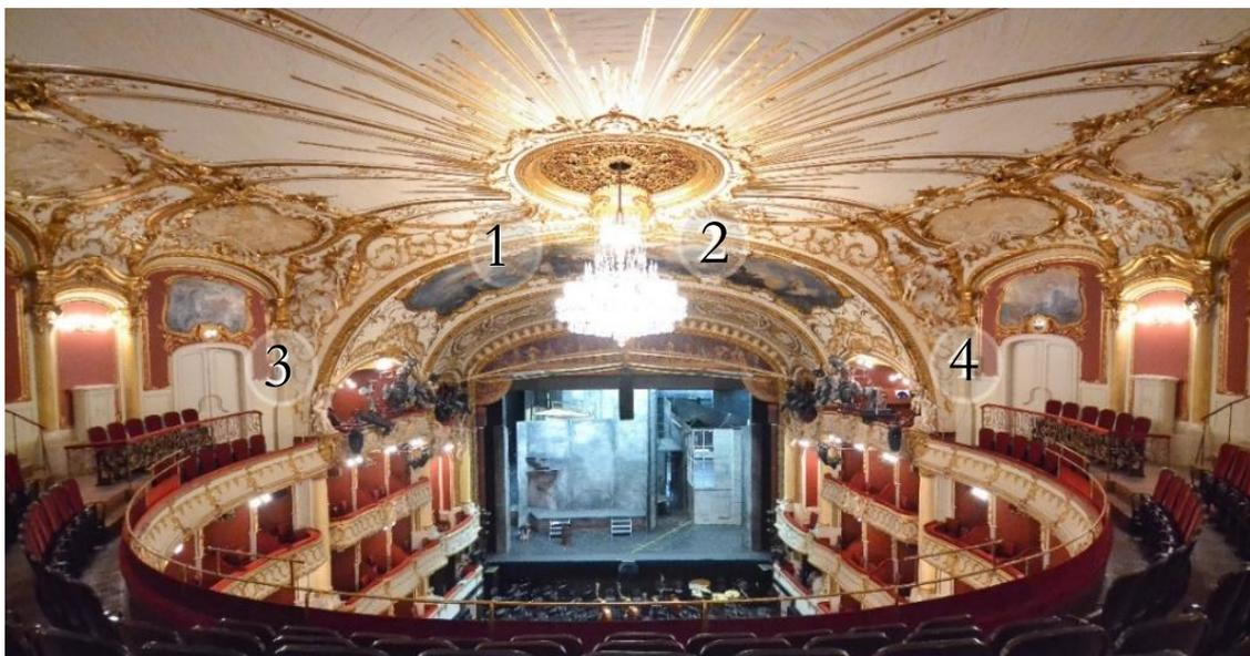
*Abbildung 28: Positionen der vier Raummikrofone während des technischen Probeaufbaus und der zwei Hörversuche. Zwei Kugelmikrofone (Sennheiser MKH8020) hängen von der Lüsterkuppel herunter und zwei sind hinter den Delaylines auf der Galerie montiert (Frühwirt 2021)*
