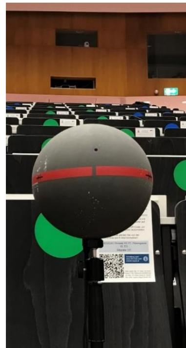
*Abbildung 8: Kugelflächenmikrofon von Schoeps, hier zu sehen während des technischen Probeaufbaus im Hörsaal P1 der TU Graz (Brühwiler 2021)*
