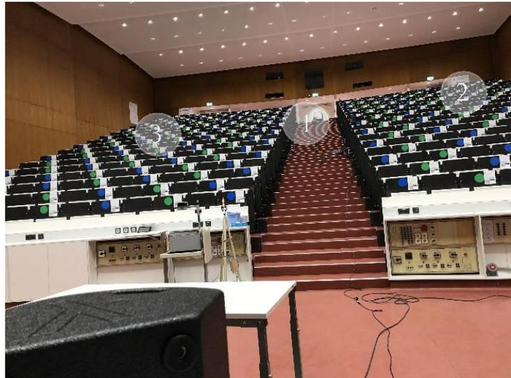
Die zwei Mikrofone wurden jeweils auf einer Sitzhöhe von ca. 1.20 m und mit einem Meter Abstand zueinander und aufgestellt. Das Kugelflächenmikrofon wurde hierbei als Ersatz zur Kunstkopferferenz verwendet, da beide als Trennflächenstereofonie funktionieren und somit ähnliche Messergebnisse zu erwarten waren.
