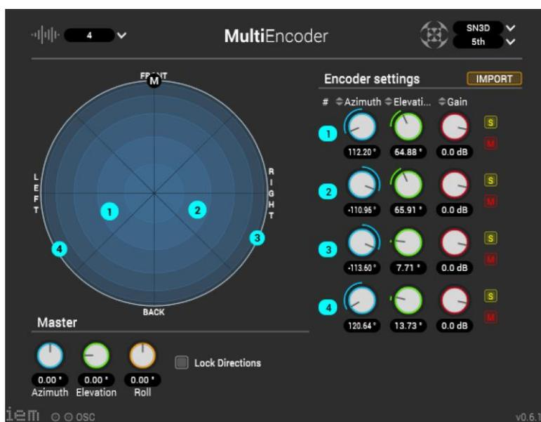
Abbildung 31: Positionierung der Raummikrofone im ambisonischen Enkoders (IEM), orientiert an den echten Positionen im Raum
