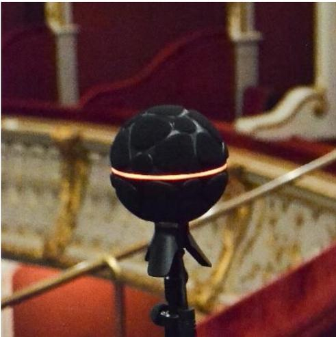
*Abbildung 9: Zylia ZM-1, ambisonisches Mikrofon dritter Ordnung, hier zu sehen während des technischen Aufbaus an der Oper Graz (Frühwirt 2021)*
