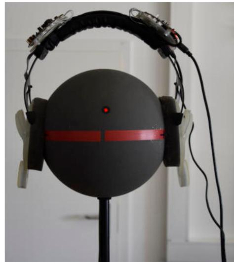
(b) Messung mit Kugelflächenmikrofon
