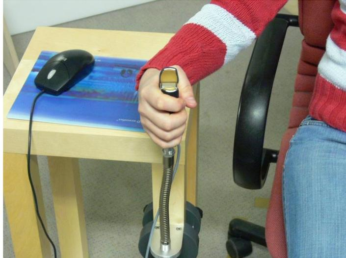
Abb. 2.2: Handkraftdynamometer
