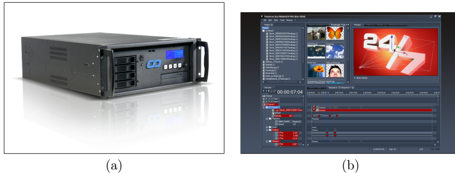
Abbildung 3.3: Coolux Pandoras Box Server (a) und zugehörige, grafische Benutzeroberfläche (b) [4]
