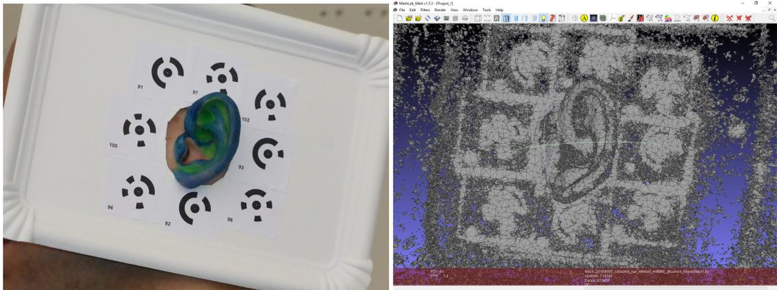
Abbildung 7.21: Helle (grün) und dunkle (blau) Farbe, damit die Pinna kontrastreicher wird (links). Dreiecke des Meshs sind etwas groß, aber die Pinna ist zufriedenstellend vollständig (rechts).
