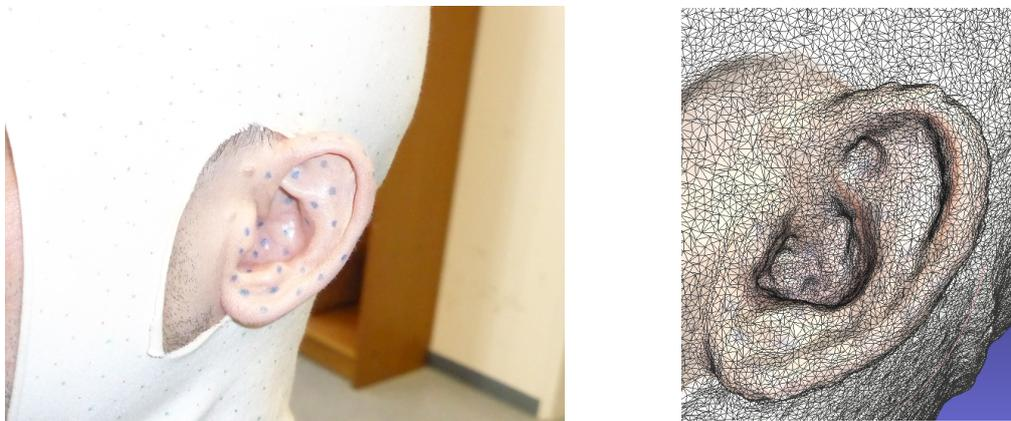
Abbildung 7.12: Makeup zur Härchenglättung und blaue zufällig verteilte Punkte mit Kajal. Fotos mit Blitz, ohne Marker.
