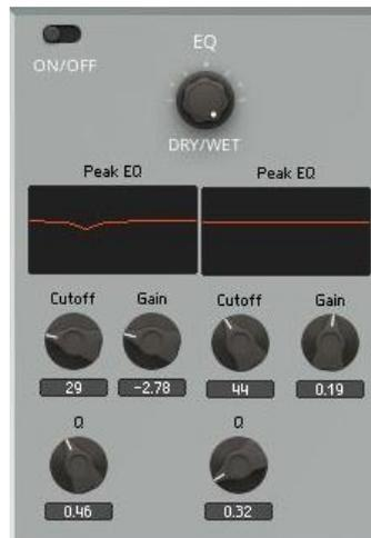
Abbildung 11: Darstellung des EQ Moduls in Reaktor
