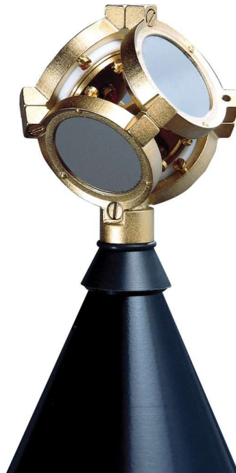
Abbildung 1: ] Das Soundfield ST450 ohne Gehäuse mit Blick auf die 4 Membranen
