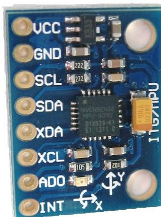
Abb. 2: Beschleunigungssensor MPU6050. [1]
