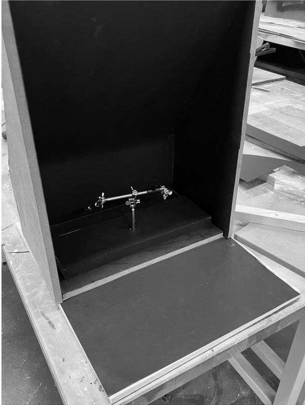
Abb. 11: Grundplatte, Steg, Lötcolbenhalterung und „Trichter“; Foto: Autor
