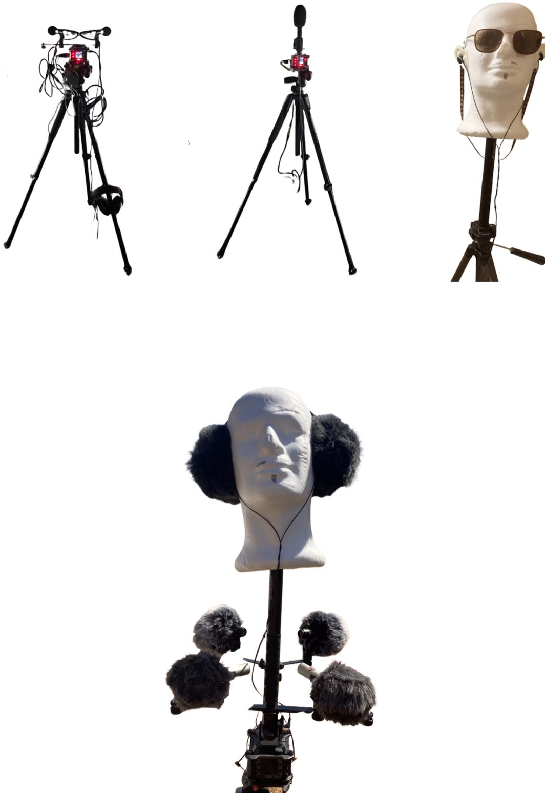
Abbildung 18, Links oben: ORTF-Test, oben mitte: Sennheiser AMBEO VR Tetraeder-Mikrofon, rechts oben: DIY Binauralkopf, unten: Kombination aus Doppel-ORTF und Binauralkopf
