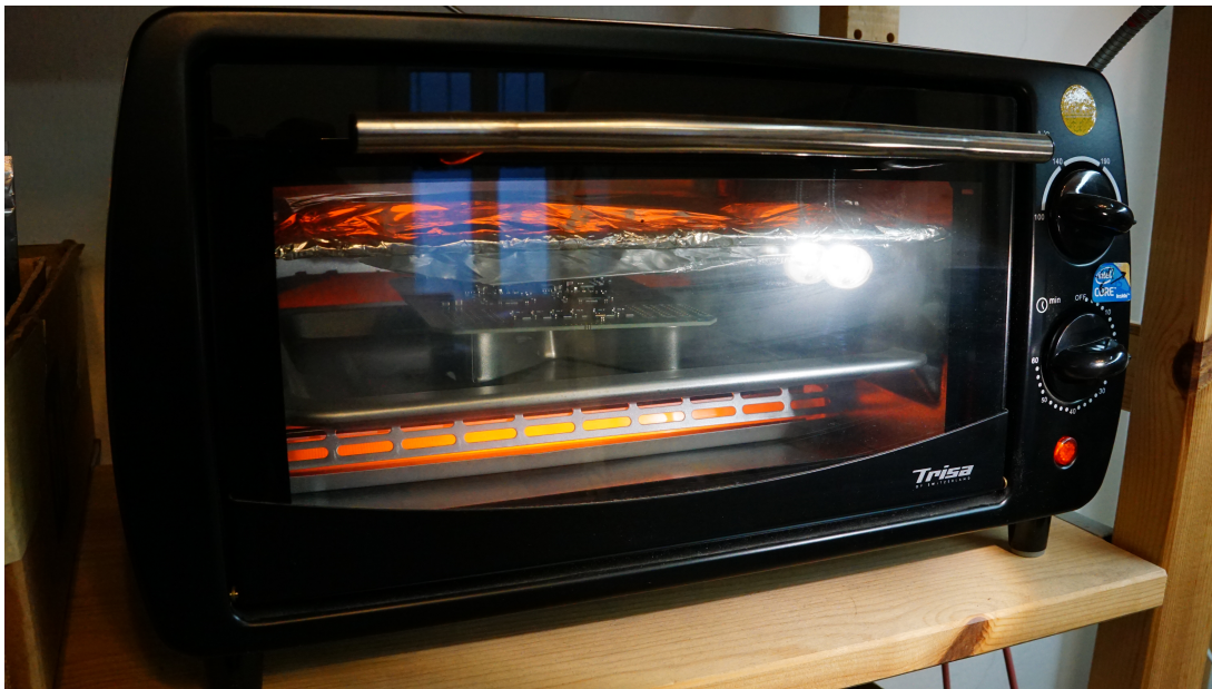
Abbildung 69: Reflow-Löten im Snackofen
