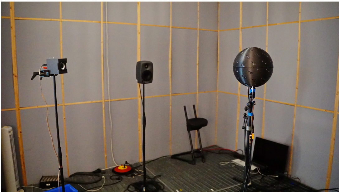
Abbildung 82: Messaufbau im Akustik-Messraum des IEM
