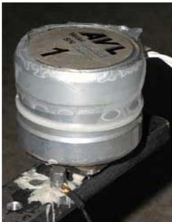
Abb. A5 Schwingerreger für die Auslöschung und Beschleunigungssensor
