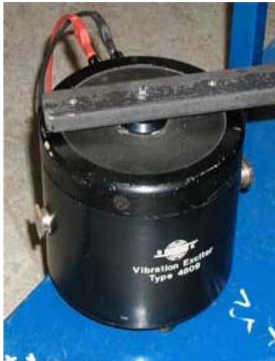
Abb. A4 Schwingerreger zur Anregung des Aufbaus
