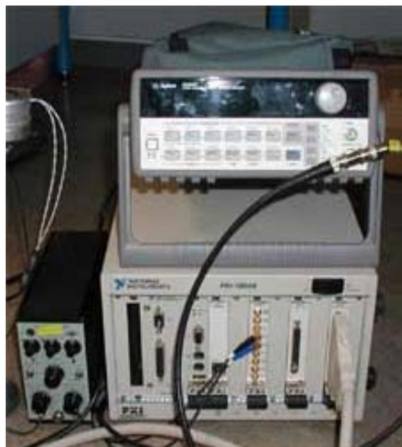
Abb. A3 Ladungsverstärker, PXI-Einheit und Frequenzgenerator
