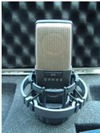
Abbildung 12 C 414 B-XLS mit umschaltbarer Richtcharakteristik
