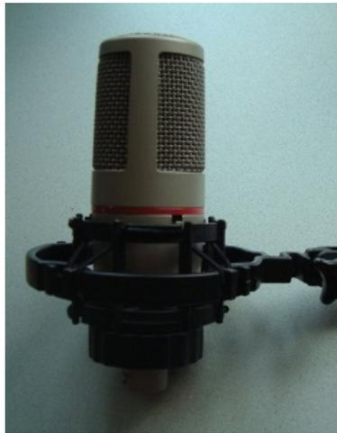
Abbildung 17 C 4000 B - Großmembran in Nierencharakteristik
