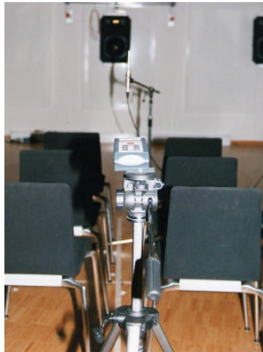
**Abb. 6.5: Messlaser, Mikrofon und ein Lautsprecher**
