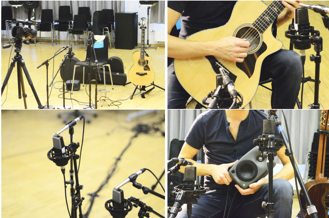
Abbildung 2: Fotodokumentation der Aufnahmesituation im Überblick, Mikrofonpositionierung (Decke und Hals), Lautsprecherposition für die Impulsantwortmessung.
