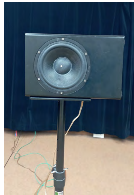
Abbildung 1.8: On-Axis Messposition ( \vartheta = 0^\circ ) des Visaton GF200 auf Drehteller im SPSC Tonstudio, Mikrophon in 1m Entfernung, links Lautsprecher aufrecht ( \varphi = 0^\circ ), rechts Lautsprecher liegend ( \varphi = -90^\circ )
