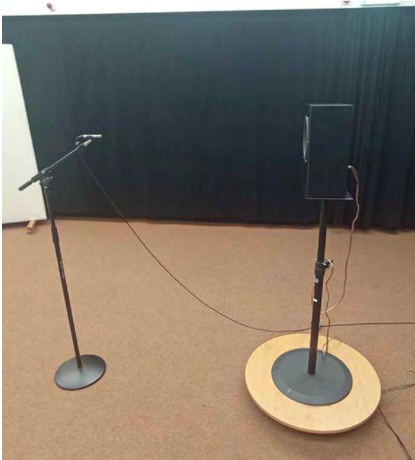
Abbildung 1.8: On-Axis Messposition ( \vartheta = 0^\circ ) des Visaton GF200 auf Drehteller im SPSC Tonstudio, Mikrophon in 1m Entfernung, links Lautsprecher aufrecht ( \varphi = 0^\circ ), rechts Lautsprecher liegend ( \varphi = -90^\circ )
