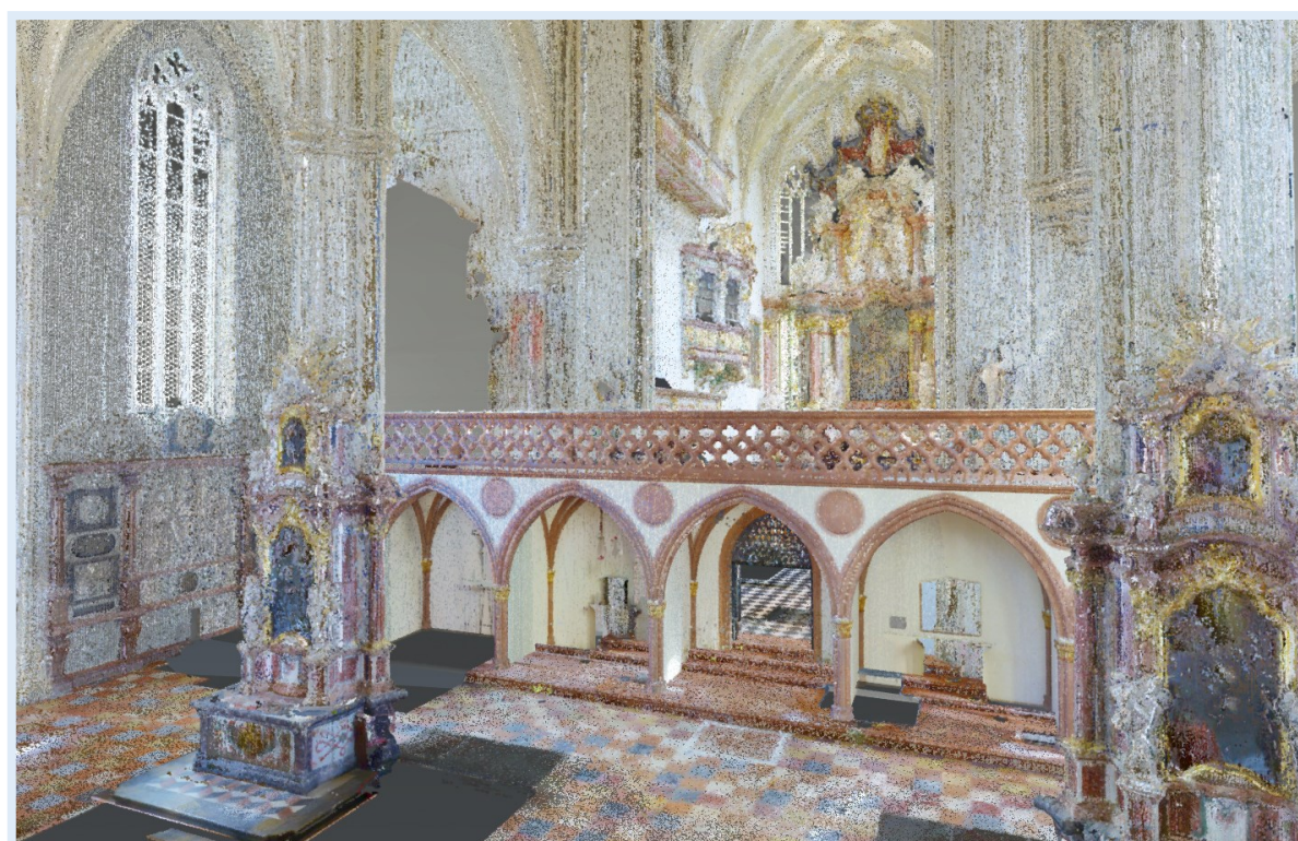
Dieser Screenshot zeigt einen wichtigen Arbeitsschritt in der Erstellung des digitalen Modells des Doms: Den Einbau des Lettners und die Entfernung aller Bauelemente, wie z.B. der Seitenaltäre, die um 1600 noch nicht vorhanden waren.
