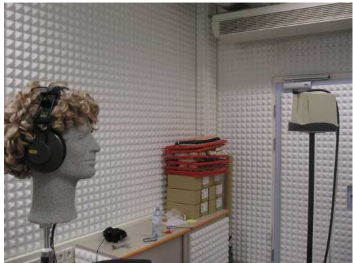
(b) Messanordnung: links Kopfhörer, rechts Ultraschallsender und Sendereinheit des Flock of Birds
