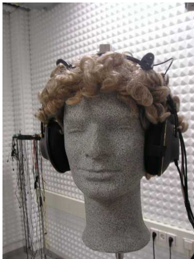
(a) Kopfhörer mit Empfängern und Referenzsensor (mitte)
