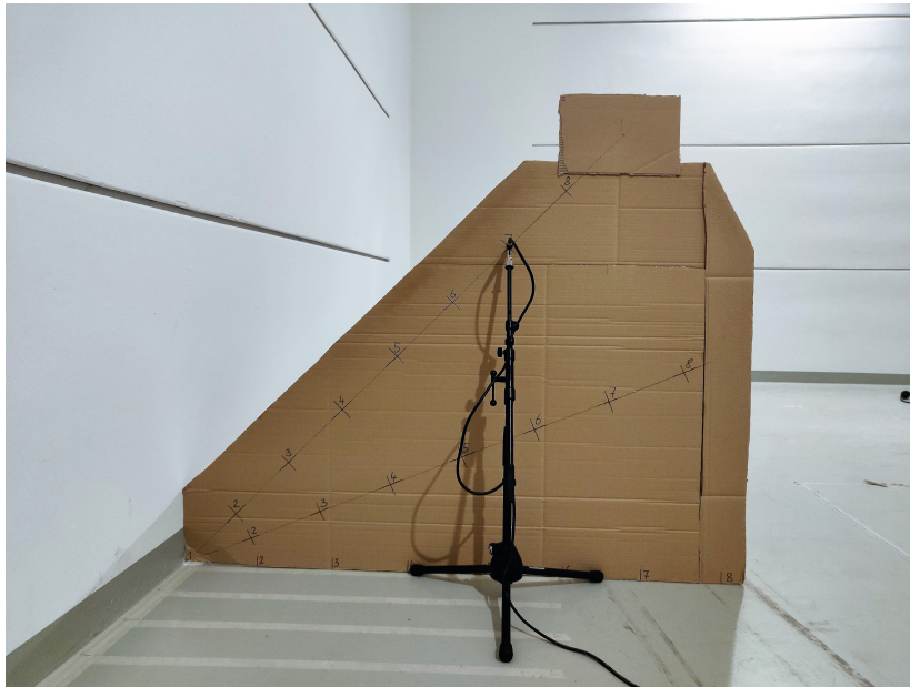
Abbildung 3.23: Ansicht der Messschablone sowie der pv-Sonde am Beispiel von MP 7 bei den Messungen ohne KA (MK 4)
