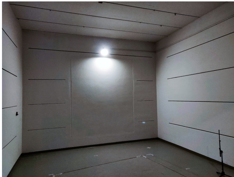
Abbildung 3.10: Der Hallraum des Instituts für Bauphysik ohne PR und Diffusoren
