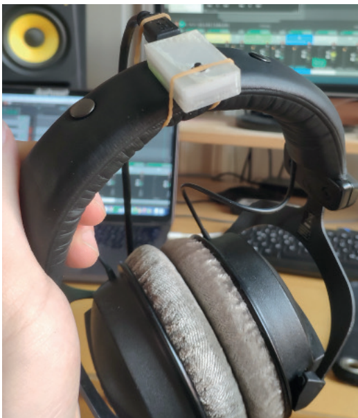
Abbildung 10: Headtracker auf Kopfhörern (Beyerdynamics DT 770 (80 Ohm))
