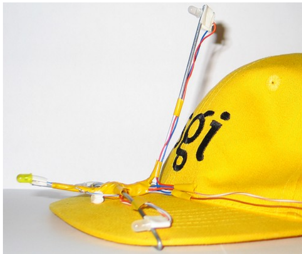
Abbildung 6.7: Leuchtdioden auf Kappe als Marker für die Software FreeTrack
