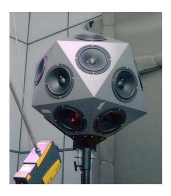
Abbildung 2.2: Kugelförmige Lautsprecheranordnung, Ikosaederlautsprecher. Messung der Impulsantwort eines Lautsprecherchassis mittels Laservibrometer [Zot09].
