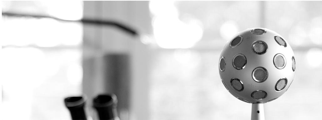
Abbildung 1 – Das Eigenmike der Firma mh acoustics, mit Sitz in San Francisco, hat 32 Mikrofonskapseln an der Kugeloberfläche und kann Ambisonicsignale bis zu vierter Ordnung aufzeichnen. Foto: <http://www.mhacoustics.com>
