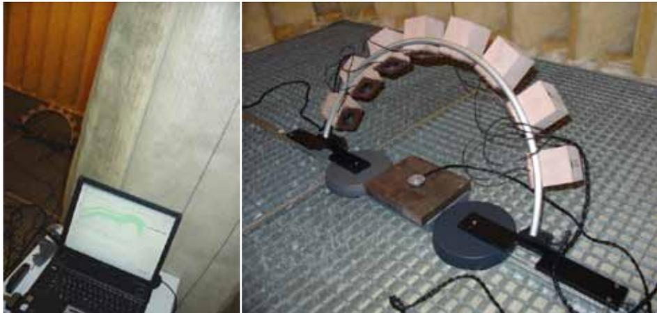
Abbildung 32: Vermessung des Mikrofonarrays im Messraum mit identer Konfiguration wie im PKW
