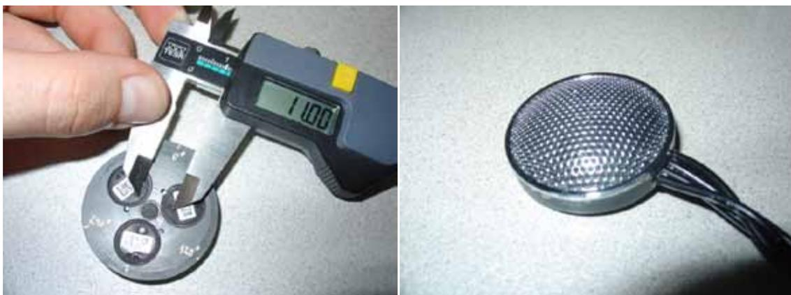
Abbildung 4: Die zwei verwendeten Arrays: ohne (links) und mit Windschutzkappe (rechts)
