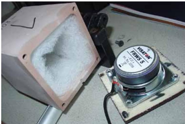
Abbildung 20: gedämpftes Lautsprechergehäuse mit montiertem Chassis
