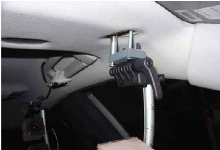
Abbildung 18: Montagevorrichtung für die Messposition *Handgriff Fahrer*
