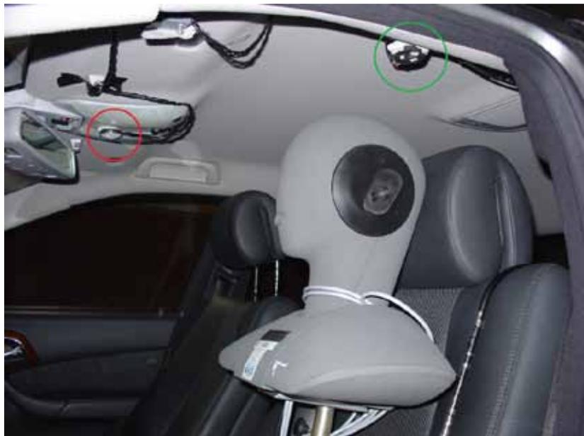
Abbildung 25: Kunstkopf im Auto, gut zu sehen sind auch die zwei verschiedenen Varianten des Mikrofonarrays an den Positionen *Dachbedieneinheit* (rot) und *Handgriff Fahrer* (grün)
