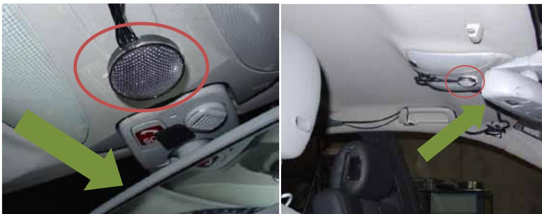
Abbildung 58: Mikrofonarray und Rückspiegel bei der Mikrofonposition *Dachbedieneinheit*
