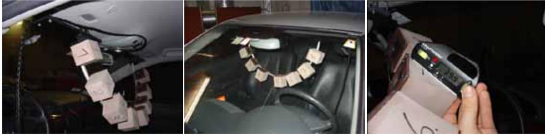
Abbildung 24: Messung mit dem Messbogen im PKW, Winkelkontrolle mit digitaler Wasserwaage
