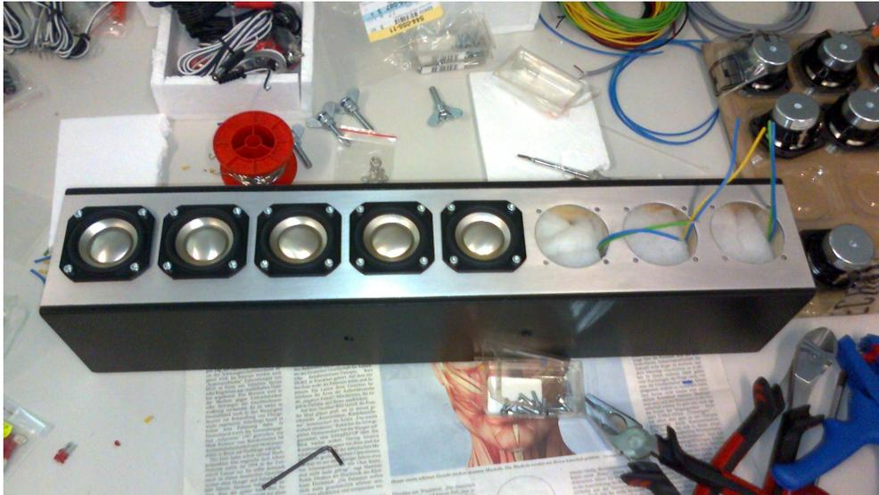
*Abbildung 8: Gehäusefront - Einbau der Lautsprecherchassis*
