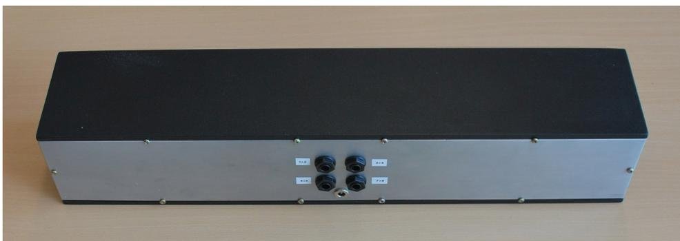
*Abbildung 10: Rückseite des Gehäuses - Eingangsbuchsen für Signale sowie Stromversorgung*
