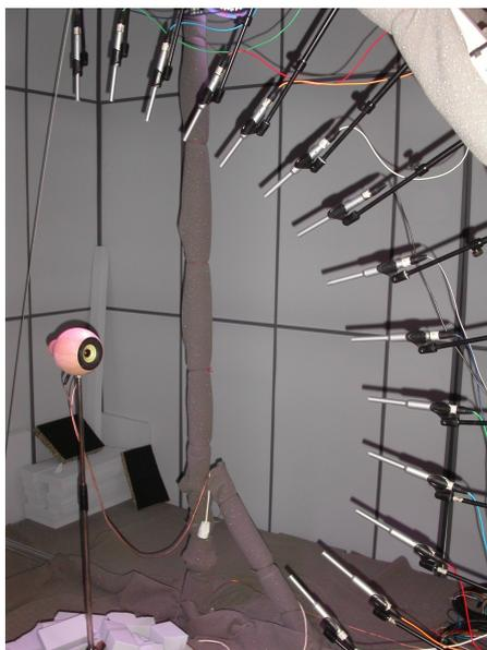
Abbildung 5.3.: Messung nach 2-Flächen-Verfahren am IEM
