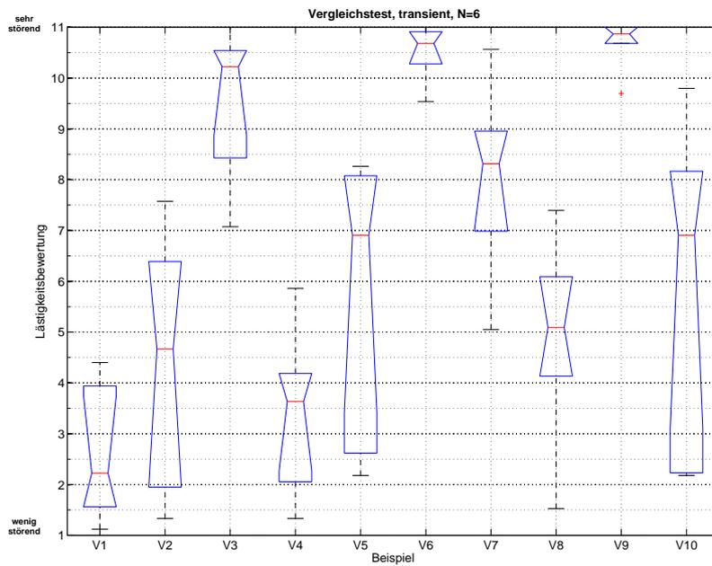
Abbildung 5.2.: Boxplot des Direktvergleichs, Vorversuch, transientes Geräusch
