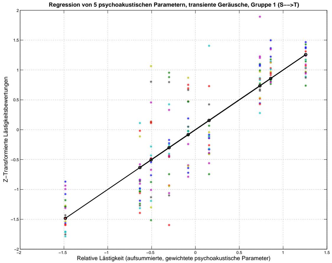
Abbildung 6.2.: Darstellung des berechneten Lästigkeitsmodells für transiente Geräusche
