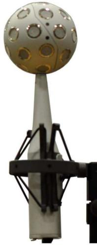
Abbildung 2.4: Kugelförmiges Mikrofonarray, Eigenmike.
