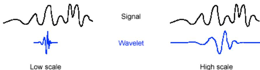
Abbildung 4: unterschiedlich skalierte Wavelets im Vergleich zum Signal
